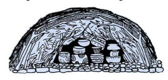
wir eine Stunde ein Feuer und räumten die Asche anschließend ab. Dann stapelten wir die vorgetrocknete Rohware in die Mitte, gestützt von Ziegelsteinen. Die Ware umgaben und füllten wir mit Sägemehl und Stroh, darauf machten wir dann fast zwei Stunden ein Feuer. Danach halfen alle, die Glut mit Erde, dicht
